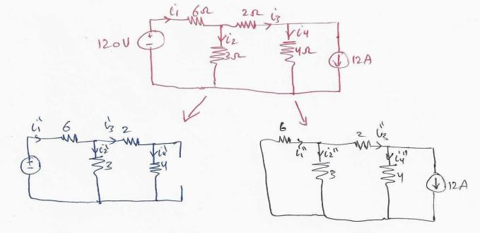
Now  $i_1 = i_1 + i_1'' = 15 + 2 = 17 A$   $i_2 = i_2 + i_2'' = r_0 + i_{-4} = 6 A$   $i_3 = i_3' + i_3'' = 5 + 6 = 11A$  $i_4 = i_4' + i_4'' = 5 + (-6) = -1A$
