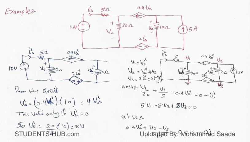
$$5 V_{1} - 8 V_{2} + 8 V_{3} = 0$$
