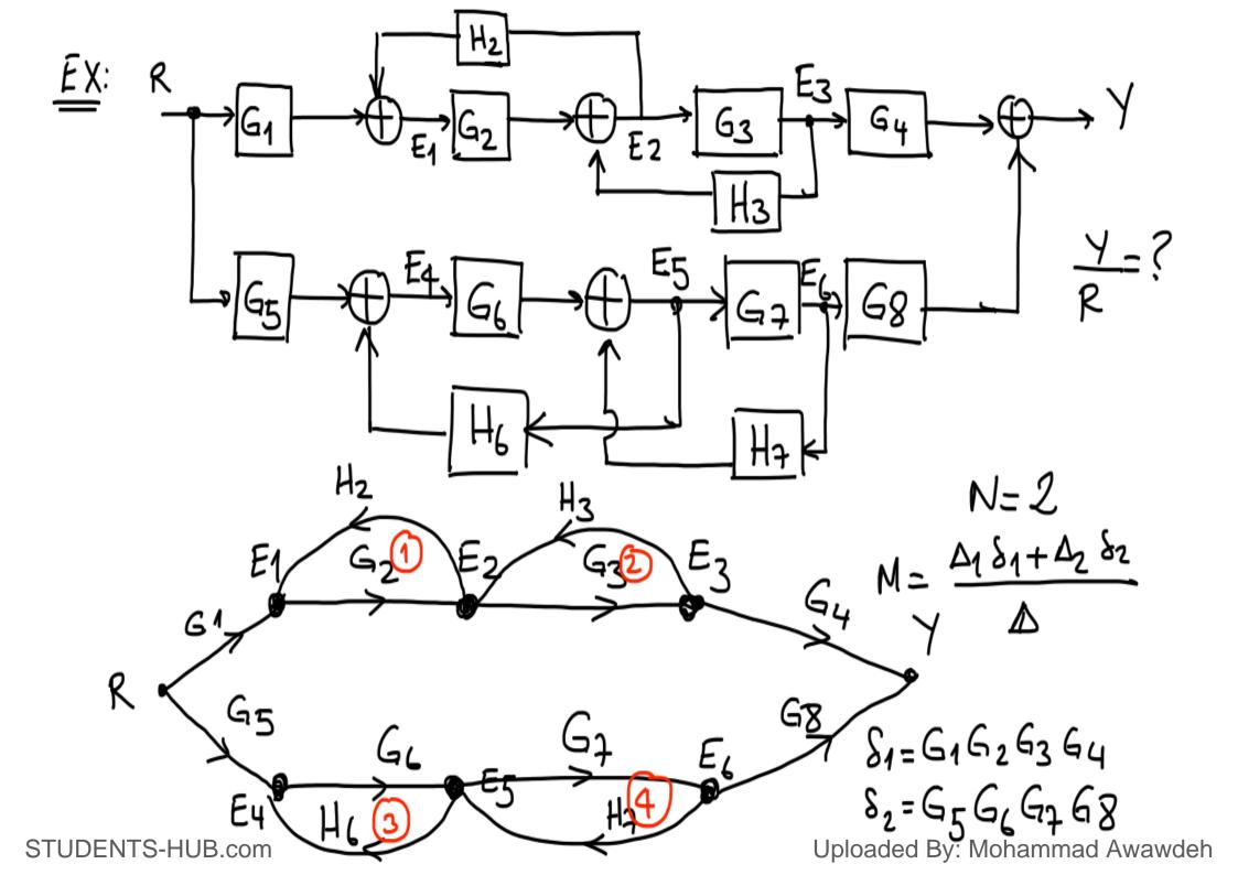
$$\Delta = 1 - (G_2 H_2 + G_3 H_3 + G_6 H_6 + G_8 H_4)$$
