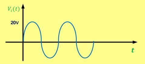
$$i_D(t) = \frac{V_i(t) - 10}{R_L} > 0$$
