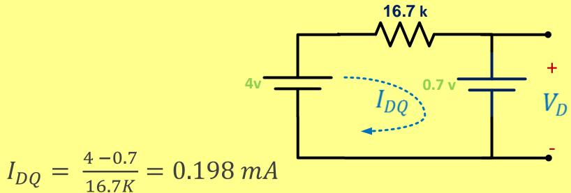
$$V_{DQ} = V_K = 0.7 V$$
