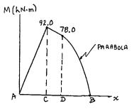
$|M|_{\text{max}} = 92.0 \text{ kN} \cdot \text{m}$
