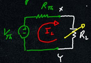
$$I_{L} : \frac{V_{TA}}{R_{TA} + R_{L}}$$
