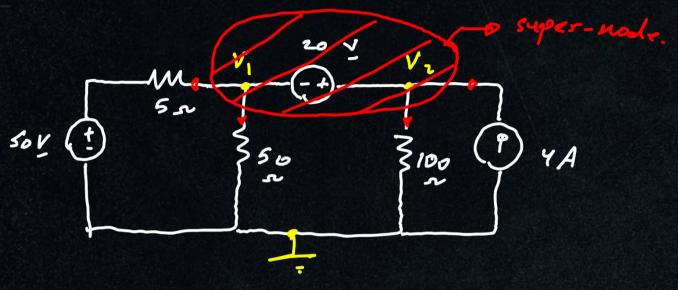
$$\frac{V_1 - 60}{5} + \frac{V_1 - 0}{50} + \frac{V_2 - 0}{100} + (-4) = 0$$
