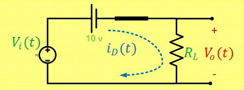
$$i_D(t) = \frac{V_i(t) - 10}{R_L} > 0$$
