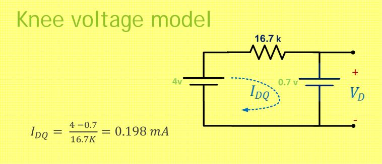
$V_{DQ} = V_K = 0.7 V$
