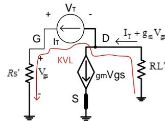
$$\text{KVL : } RL'(I_T + g_m V_{gs}) + I_T R_{s'} = V_T$$
