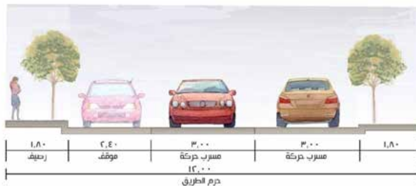
شكل 4: مقاطع عرضية متعددة لطرق تجميعية في المنطقة الحضرية لأبعاد مختلفة من حرم الطريق
