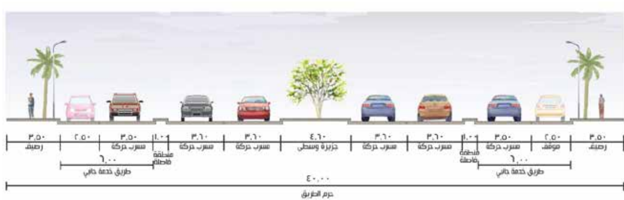
شكل 10: مقطع عرضي نموذجي على طريق خدمة جانبي على كل من جانبي الطريق
