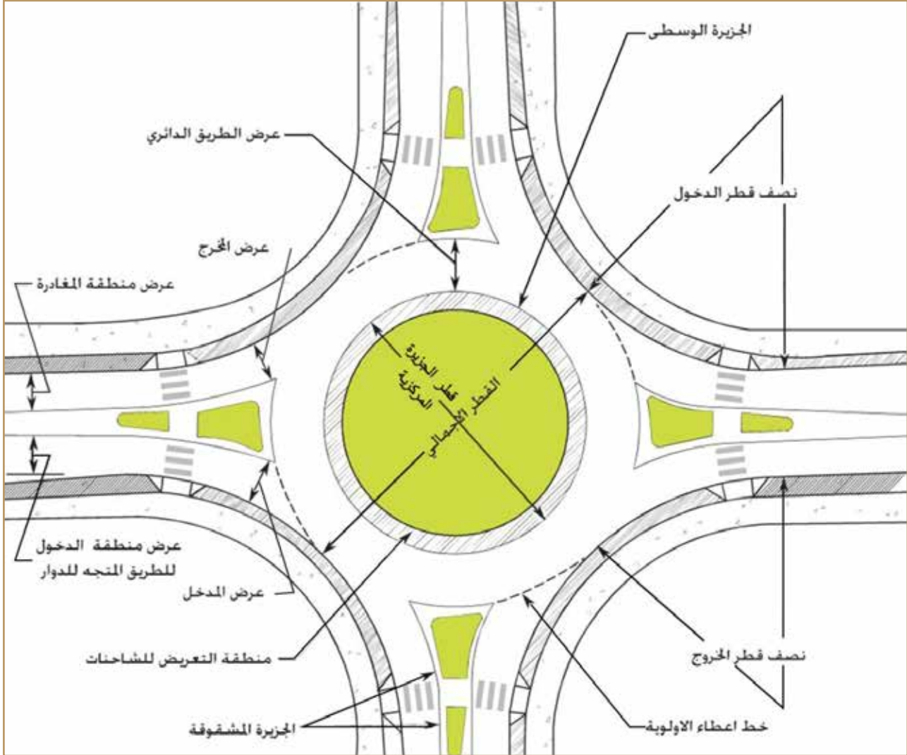
شكل 26: العناصر الهندسية الأساسية للدوار
