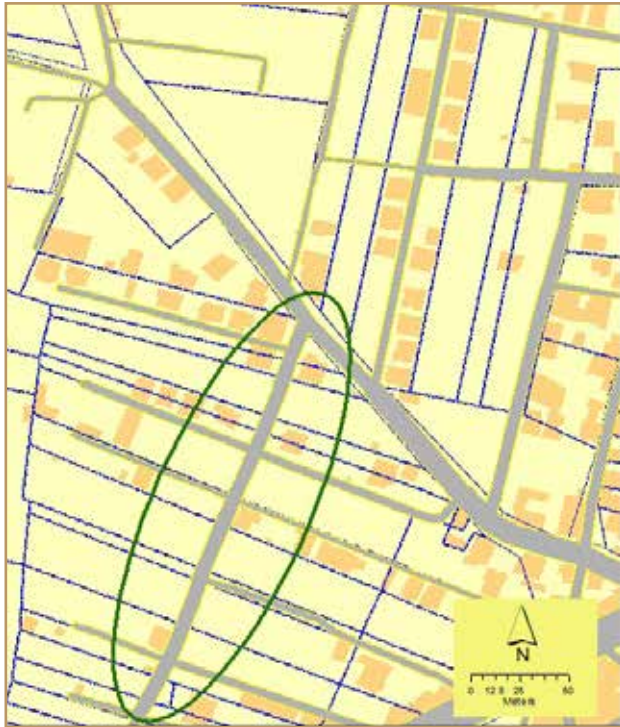
شكل 42: نموذج توضيحي لاختيار موقع الطريق في أراض طولية
