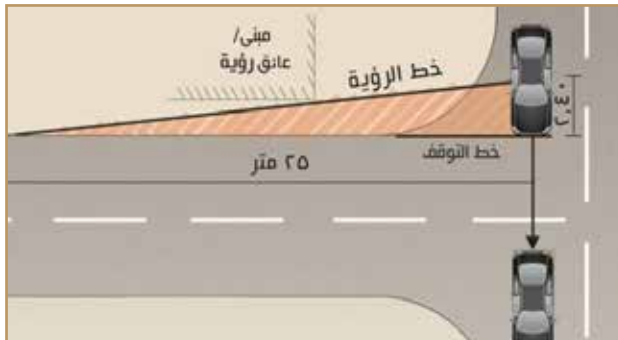
الشكل 25: متطلبات مسافة الرؤية عند التقاطع
