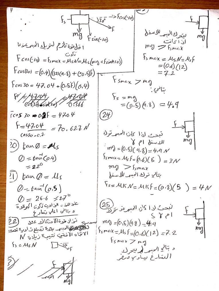
mg=4.9  $f_{smax}=(0,6)(5)=3$ mg > fsmax لتالي السبم ترك لاسفل mg-fk=ma mg0-UKF=man 4.d-(0.8)(5) =(0.5)a  $\alpha = \frac{0.9}{0.5} = 1.8$ (27) F= Fg+ma جى الحالة الأولى الالعالالالغة FS+mgSino+ma  $f_1 = f_2$ Fsi+ ma = Fsz+mgsind + ma fs, = fs2 +mysin0 mg sine >0 Fs1 > Fs2 mg sina = fs= MsW mgsind = Ms (majcas ()) Ms=ban O  $M_s = tan(37^6) = 0.75$
