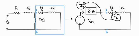
$$V_{\text{Th}} = V_{\text{oc}}$$
